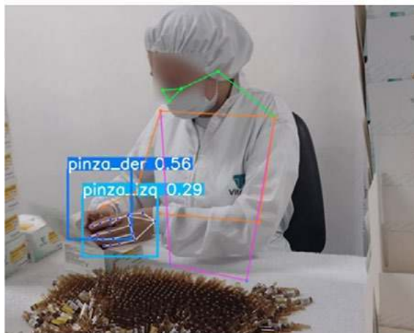
Imagen 1. Identificación de tipo de agarre y articulaciones de las manos y miembros superiores mediante algoritmos IA
