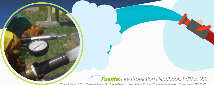
Figura 10. Medición de presión de velocidad utilizando tubo pitot
