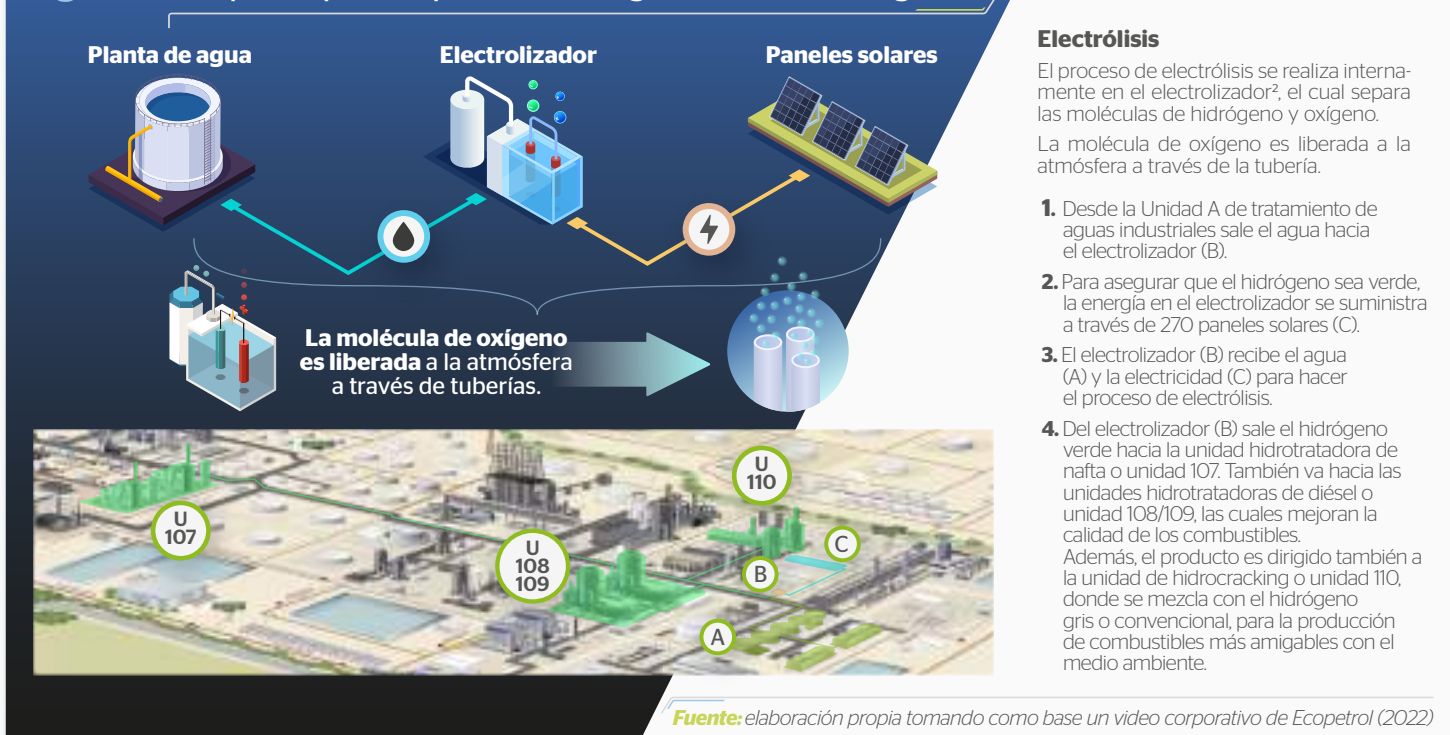
Figura 1. Así opera la primera planta de hidrógeno verde en Cartagena
