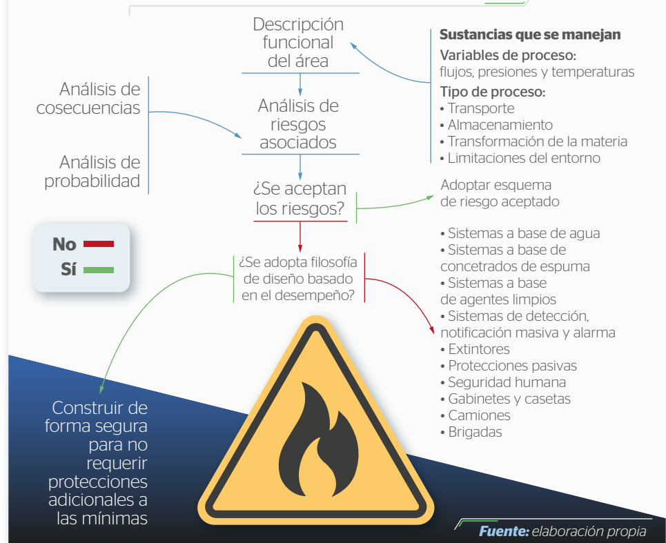
Figura 11. Esquema para análisis de riesgos para determinar estrategias de protección contra incendios en la industria oil & gas
